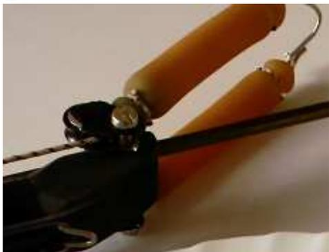
La testata deve essere preferibilmente larga quanto il fusto e deve presentare un innesto di un cilindretto Inox di diametro 12mm. esterno, internamente forato e filettato M8.
